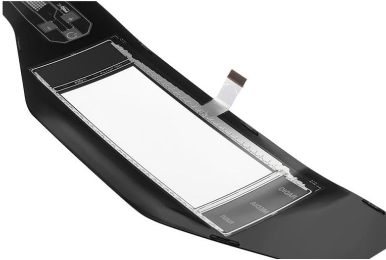
Folientechnik, rückseitig Printed Electronics Folie, Vorderseite IMD, zwischen beiden Folien wird Spritzgegossen. Hierbei muss die Printed Electronics Folie an jeder Stelle die gleiche Kunststoffwanddicke aufweisen
