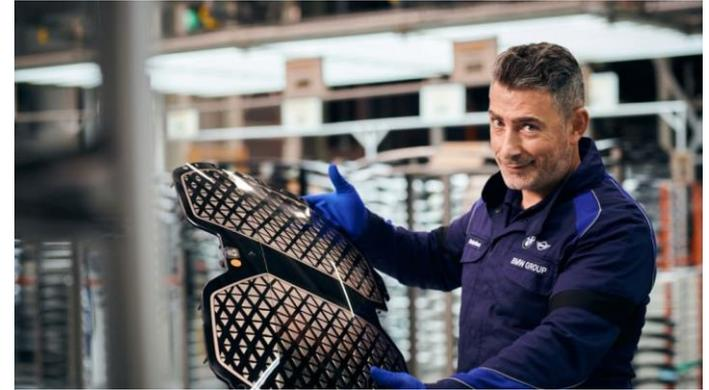
BMW iX Niere wird im Reinraum (Engel) als erste Serienanwendung für das kombinierte Folienhinterspritzen und Überfluten mit Polyurethan im Fahrzeug-Exterieur umgesetzt
