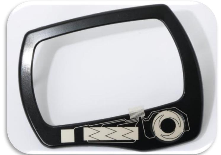
Folientechnik, die Frontseite ist dekorativ und auf der Rückseite wird die Elektronik gedruckt. Herausforderung ist die Umformung der Leiterbahnen, Wash-out und bestückte Elektronik & Leiterbahn darf sich nicht auf der Oberfläche abzeichnen
